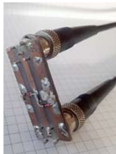
Photo 3 : Montage d'essais du limiteur
