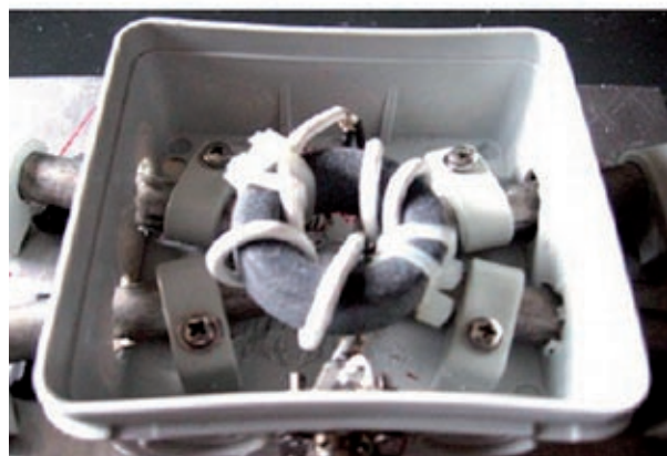
2X3 spires de RG174 Tore D33 d18 h13 en mm Al environ 2500
