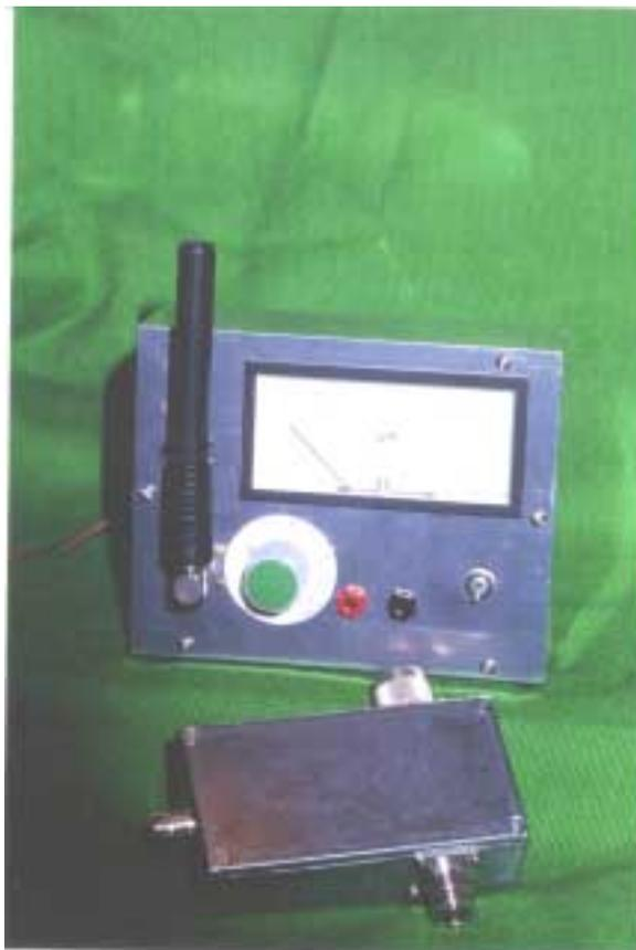
Photo 1 Le milliwattmètre et le coupleur -50dB
