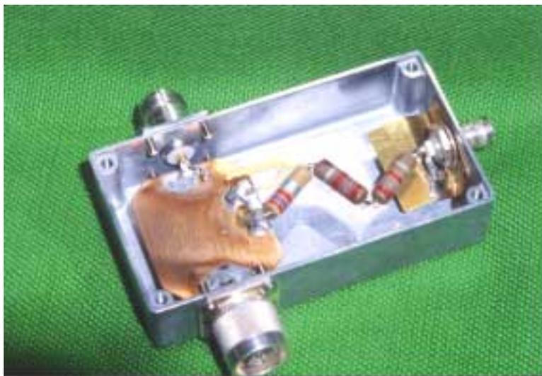
**Photo 2** Le coupleur - 50 dB, avec deux fils (peu visible, car jaunes) torsadés pour la capacité.
