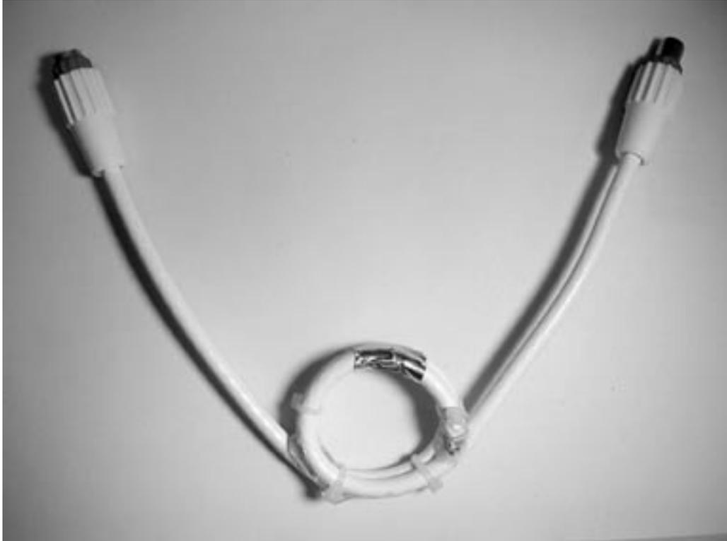
Au cours de l'été, les orages et les effets de la foudre provoquent des dégâts importants aux téléviseurs et souvent irrémédiables aux installations de l'antenne. Le présent dispositif apporte une protection supplémentaire contre les courants de gaine qui circulent sur le câble d'antenne. Ces courants s'écoulent généralement entre l'antenne et la masse châssis du téléviseur. En effet, le téléviseur réalise la jonction entre deux réseaux différents :
