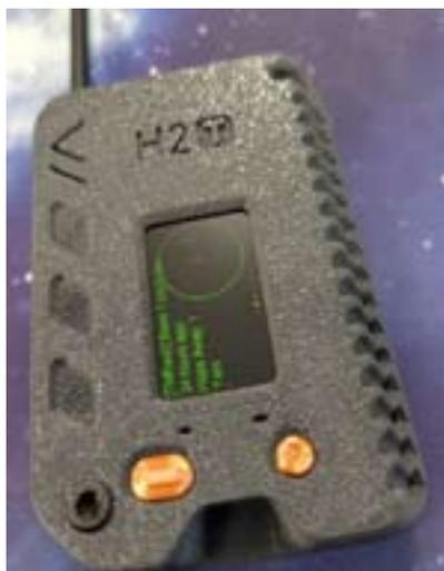
Node connecté en Bluetooth au smartphone, boîtier en impression 3D
