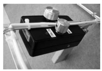
On doit la conception originale de ce récepteur 144 MHz à F8AZG. La structure du schéma avec des mélangeurs symétriques (SA612) et l'amplificateur BF LM386 permet en trois circuits intégrés d'avoir un récepteur démodulant la BLU à partir de 0.1µV environ. En réalisant trois exemplaires à partir de la description du site de l'ARDF France, je me suis rendu compte du compromis étonnant entre la simplicité et l'excellente dynamique d'atténuation sur plus de 80dB!
