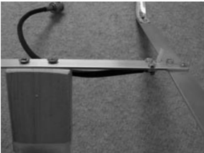
Au centre de l'antenne on fixera un tasseau ou un bout de manche à balais de un mètre environ pour porter l'antenne. Mieux encore, le récepteur sera fixé sous l'antenne avec une poignée faite de 20cm de tasseau de 20x55mm de section. Les angles du tasseau sont arrondis à la ponceuse à bande.
