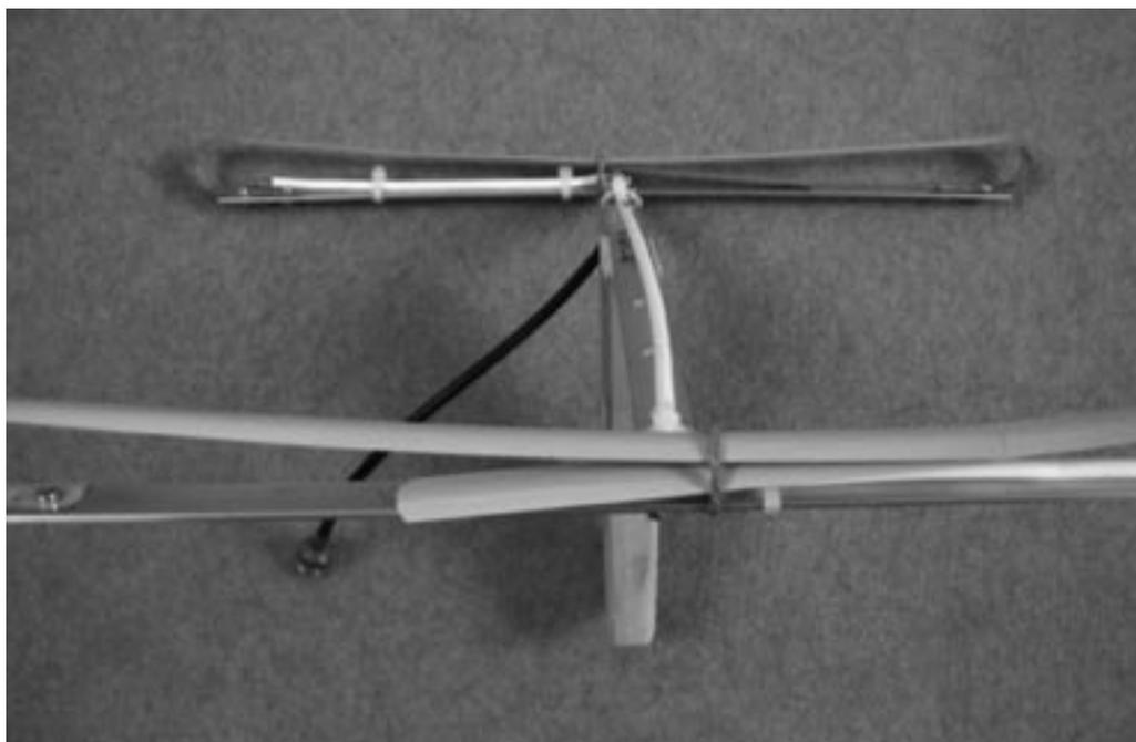
L'adaptation d'impédance de cette antenne ou TOS n'est pas optimisée vu que les distances des lignes ont été raccourcies pour réaliser l'antenne dans un mètre d'aluminium.
