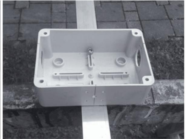
le boîtier avec la fiche montée - premier essai sur le boom après perçage
